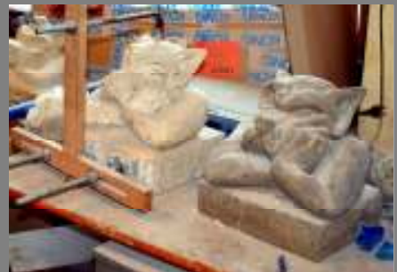
(8) Übertragung eines Modells mit dem Punktiergerät
