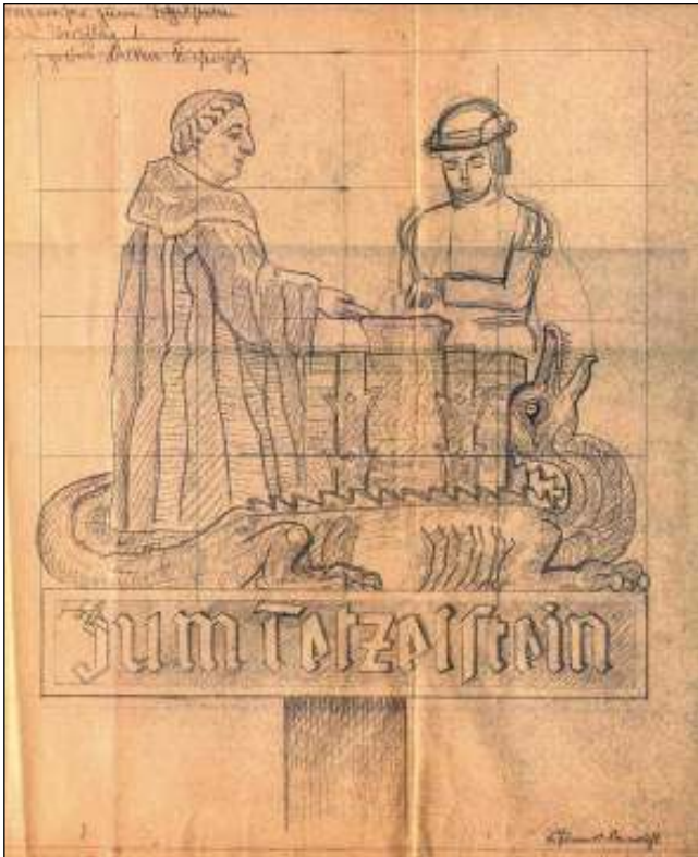
Vermerke auf dem Entwurf: Maßstab 1:4, Wegweiser zu Tetzelsstein, Mönch und Goldkiste, Vorschlag 1 , Ausführung: Eichenholz, getönt / Balken: Kiefernholz, Schrift: erhaben
